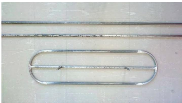
Structure en tube d'acier de 23 mm de diamètre
