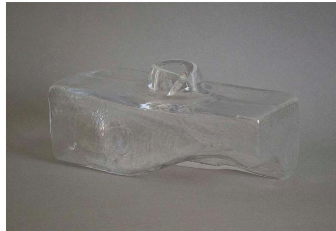
Résultat obtenu par soufflage dans un moule en bois rectangulaire à l'intérieur duquel nous avons intégré des formes partiels de sabots.
