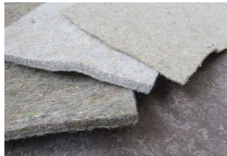
Non-tissés 100% lin de chez eco-technilin, non-tissés associés à une fibre polymère thermoplastique (PP) de chez eco-technilin, non-tissés de jeans recyclés de chez CENT.
