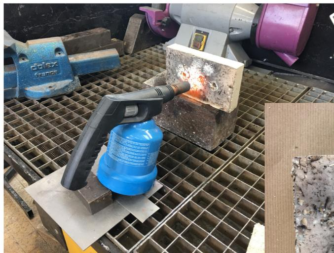
combustion du béton-chanvre
