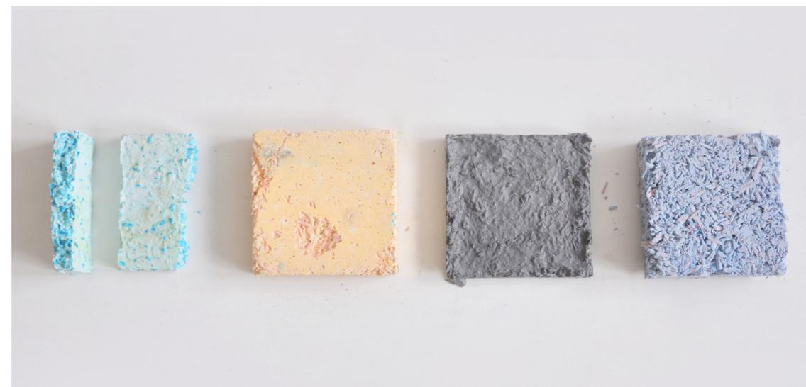
Echantillons de béton-chanvre colorés avec des pigments
