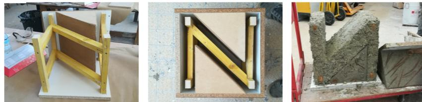
Première expérimentation avec une structure bois sur laquelle on vient couler le béton-chanvre.
