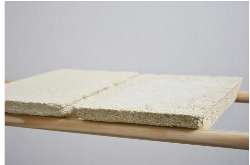
photo d'essais de briques en béton chanvre
