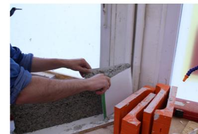
Premier test avec un moule en plastique et coulage d'une brique de chanvre.
