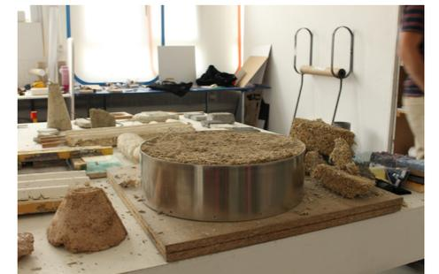
Moulage du béton chanvre dans un moule circulaire.
