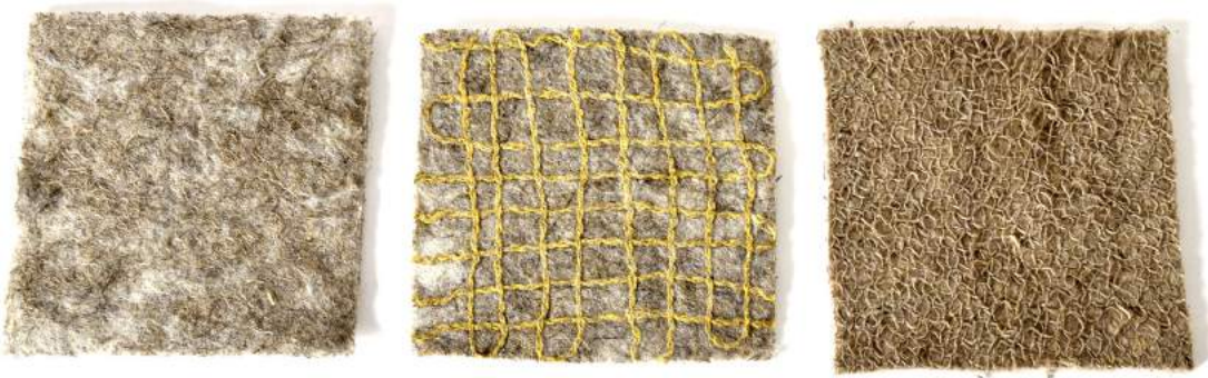
Échantillons de feutre, en partant de la gauche : feutre 50% laine et 50% chanvre; feutre 50% laine, 50% chanvre et maillage de fil de laine; feutre de 50% laine, 50% chanvre et filet de fil de chanvre.
