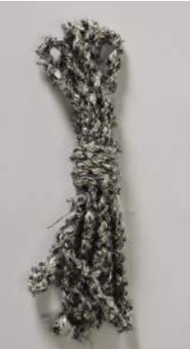
Le cordage est une solution simple pour introduire le chanvre dans l'industrie textile puisque les fils de carets n'ont pas besoin d'être normés.
