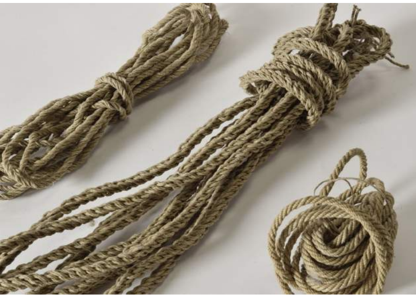
Le sens de rotation des torons influe sur le résultat final. Ces 3 cordes sont fabriquées avec la même quantité de chanvre.
