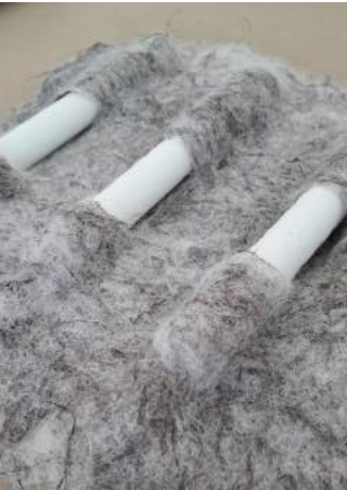
Essai d'intégration de tuyau PVC avec du feutre 50 % laine / 50% chanvre
