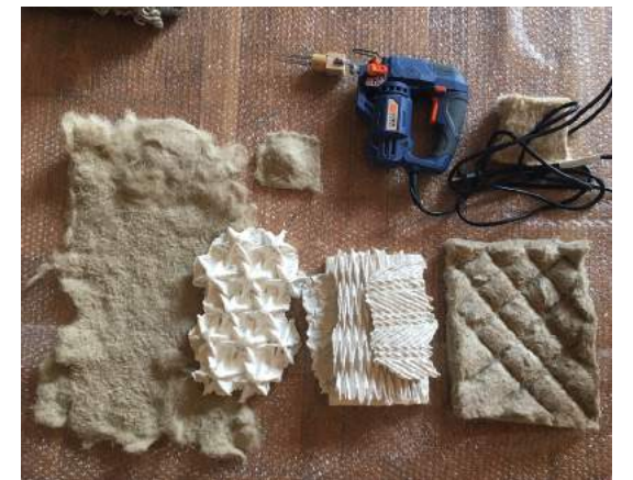
Échantillons de moulage en papier et feutre de chanvre aiguilleté.
