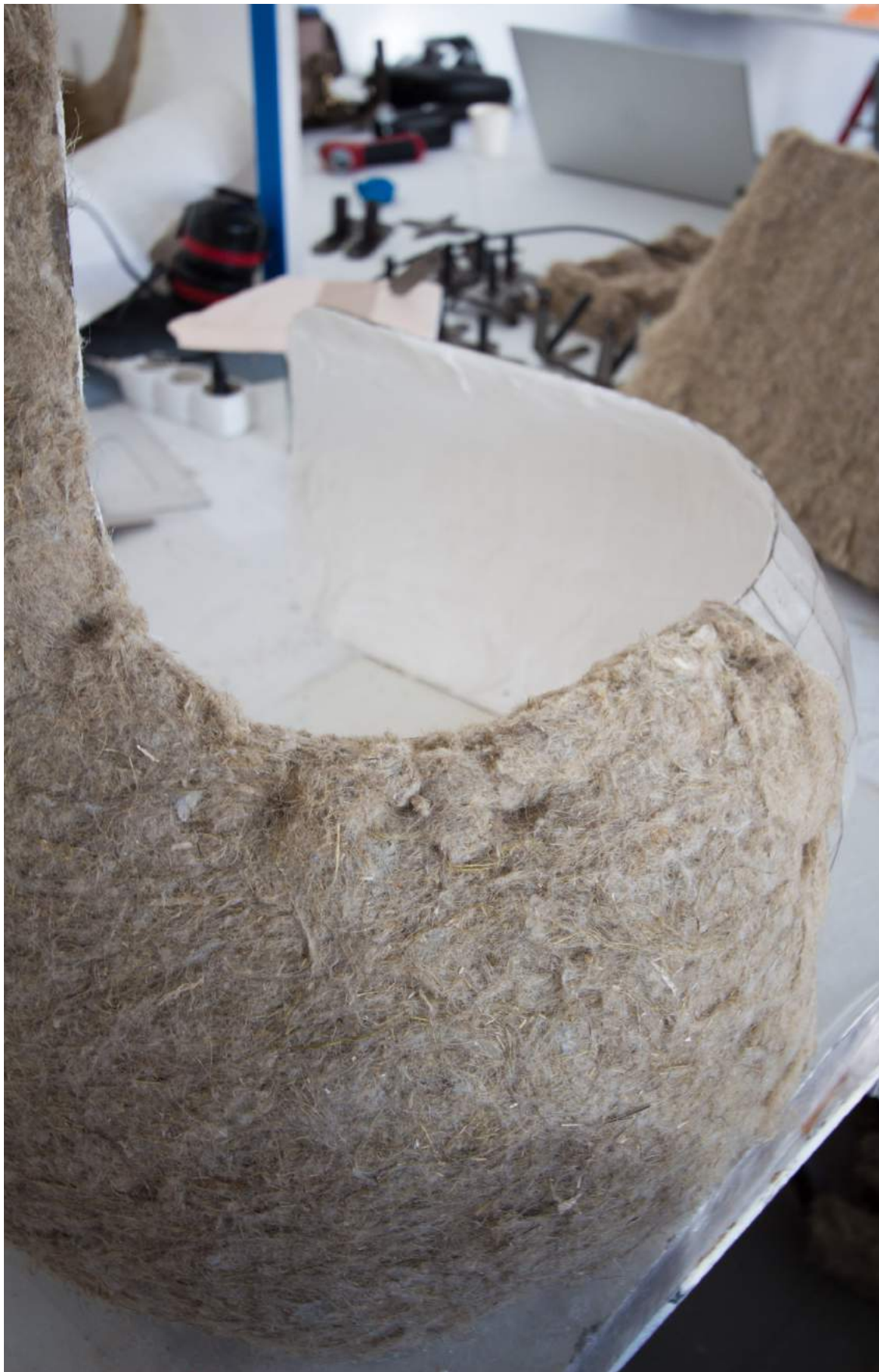
1ère étape : application du feutre de chanvre sur la contreforme.
