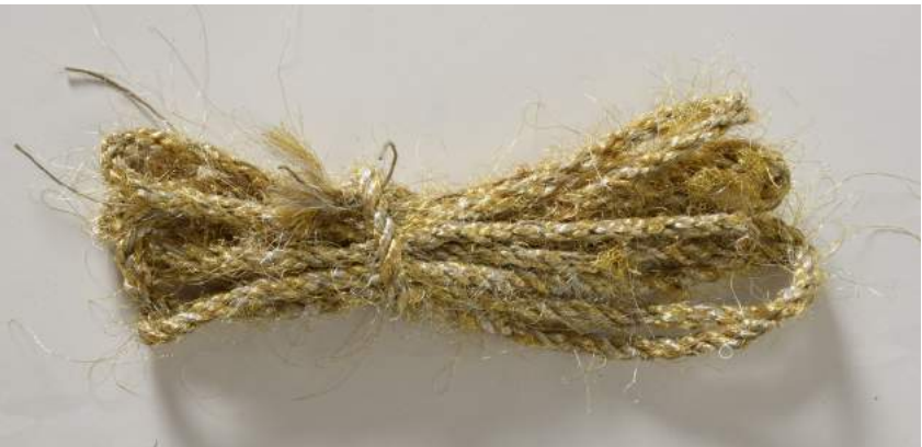
Corde hybride chanvre-plastique produite à partir de déchets industriels.
