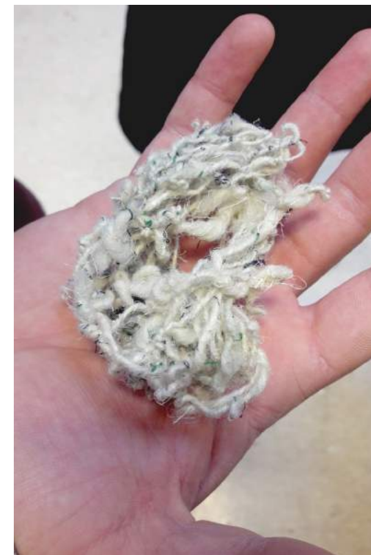
Fil obtenu au rouet : mélange de fibres de laine et copeaux de textile recyclé.
