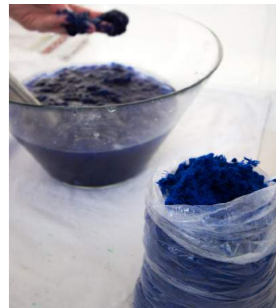
Ajout des déchets textiles de fibre de coton à la pulpe de papier de chanvre.
