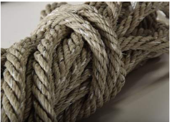
Corde à 8 torons de lin et âme en polypropylène
