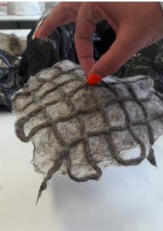
Essai de feutrage de fil de 100% chanvre avec du feutre 50 % laine / 50% chanvre
