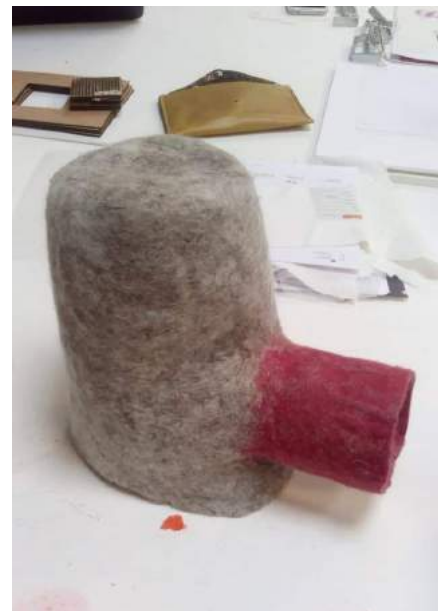
Essais de fusion de maillage avec le feutre laine/chanvre et de formes entre elles
