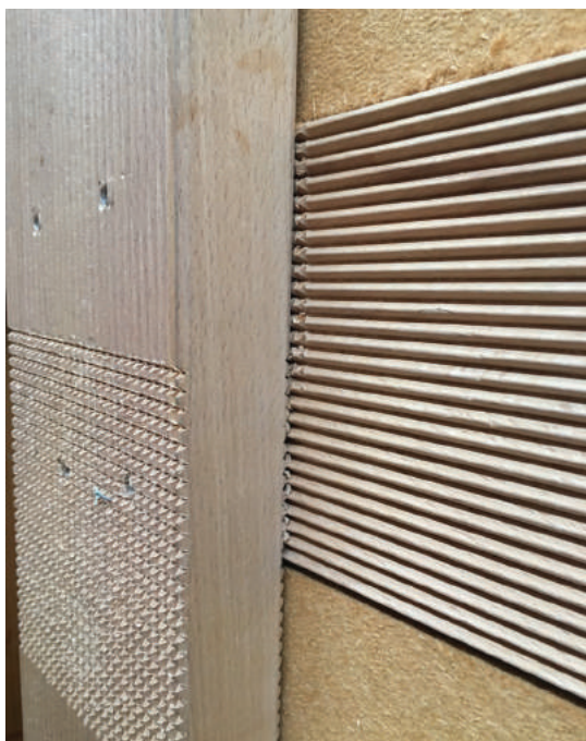
Hêtre usiné pour l'assemblage par picot
