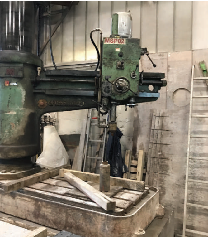
Machine à carottage, prise en photo à la graniterie Petitjean, utilisée pour la pièce 4.
