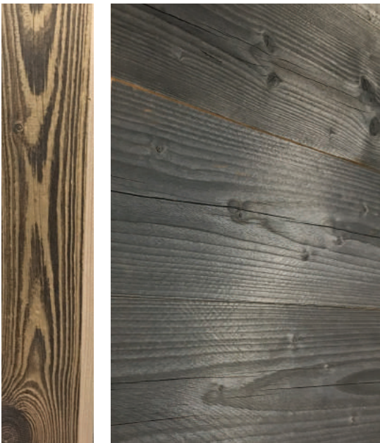
Gauche: Pin Sylvestre de récupération grisé (50 ans) Droite: Sapin grisé (6 mois)
