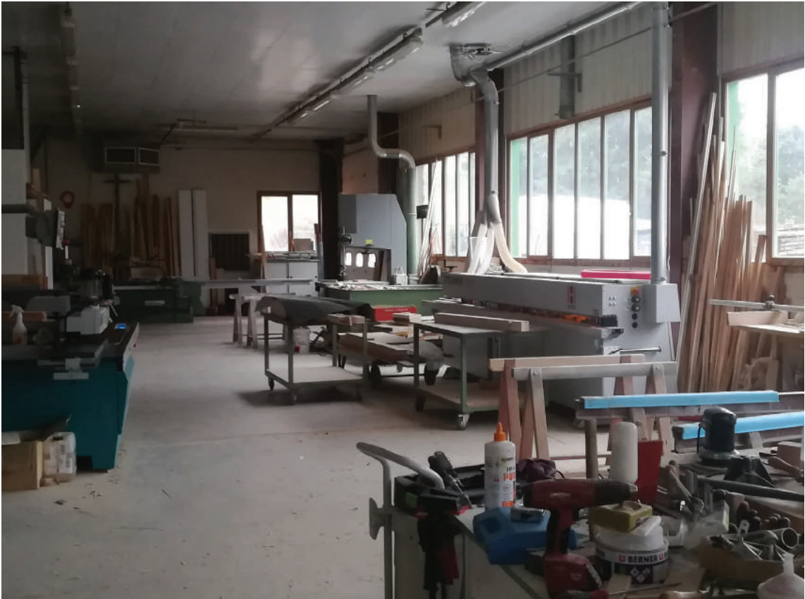
Plaqueuse de chant (premier plan ) Toupie semi-numérique (gauche) Scie à ruban (arrière plan).
