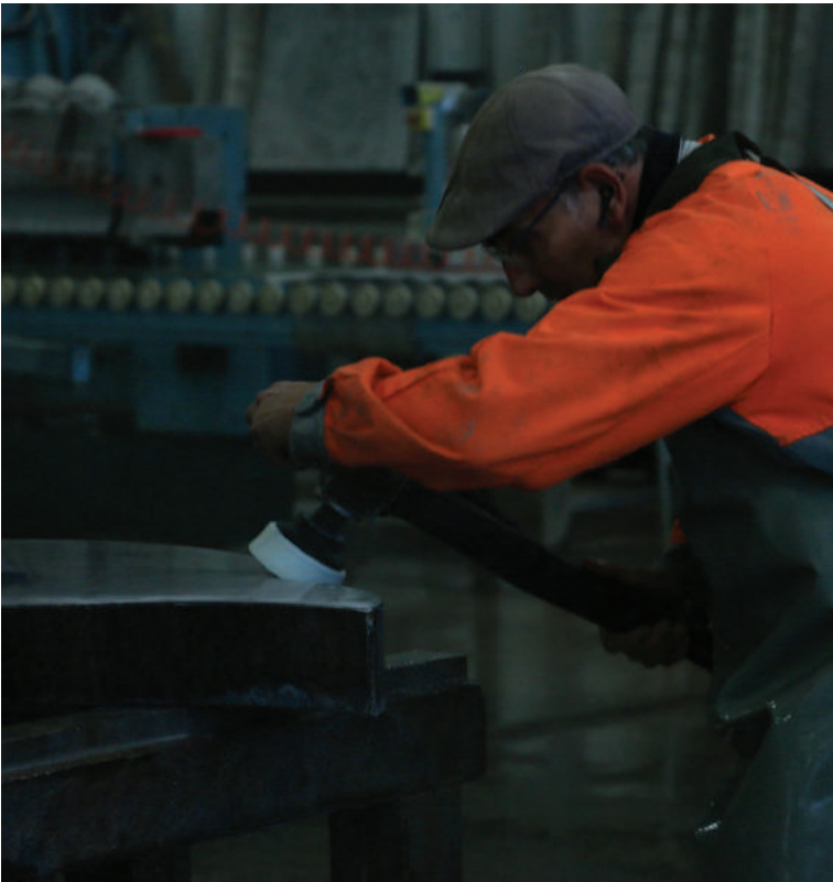
Technique de ponçage pour créer des congés, prise en photo à la graniterie Petitjean
