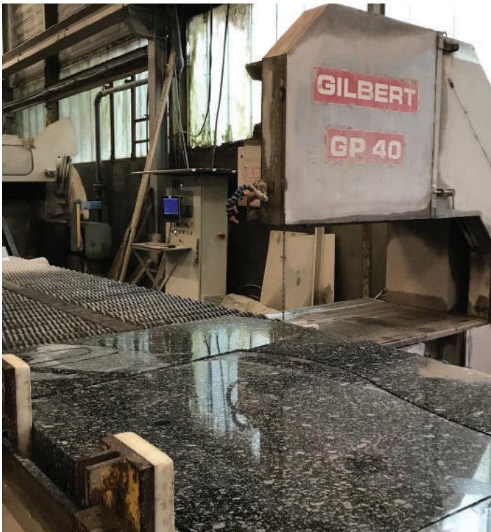
Scie courbe, prise en photo à la graniterie Petitjean utilisée pour les pièces 2 et 3.
