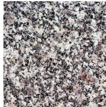
Granit « feuille morte » Granit à grain moyen et gros, d'aspect tacheté et de texture assez régulière, de coloration moyenne rouge à rouge foncé ponctuée de petites taches de feldspaths rose et rouge brun.
