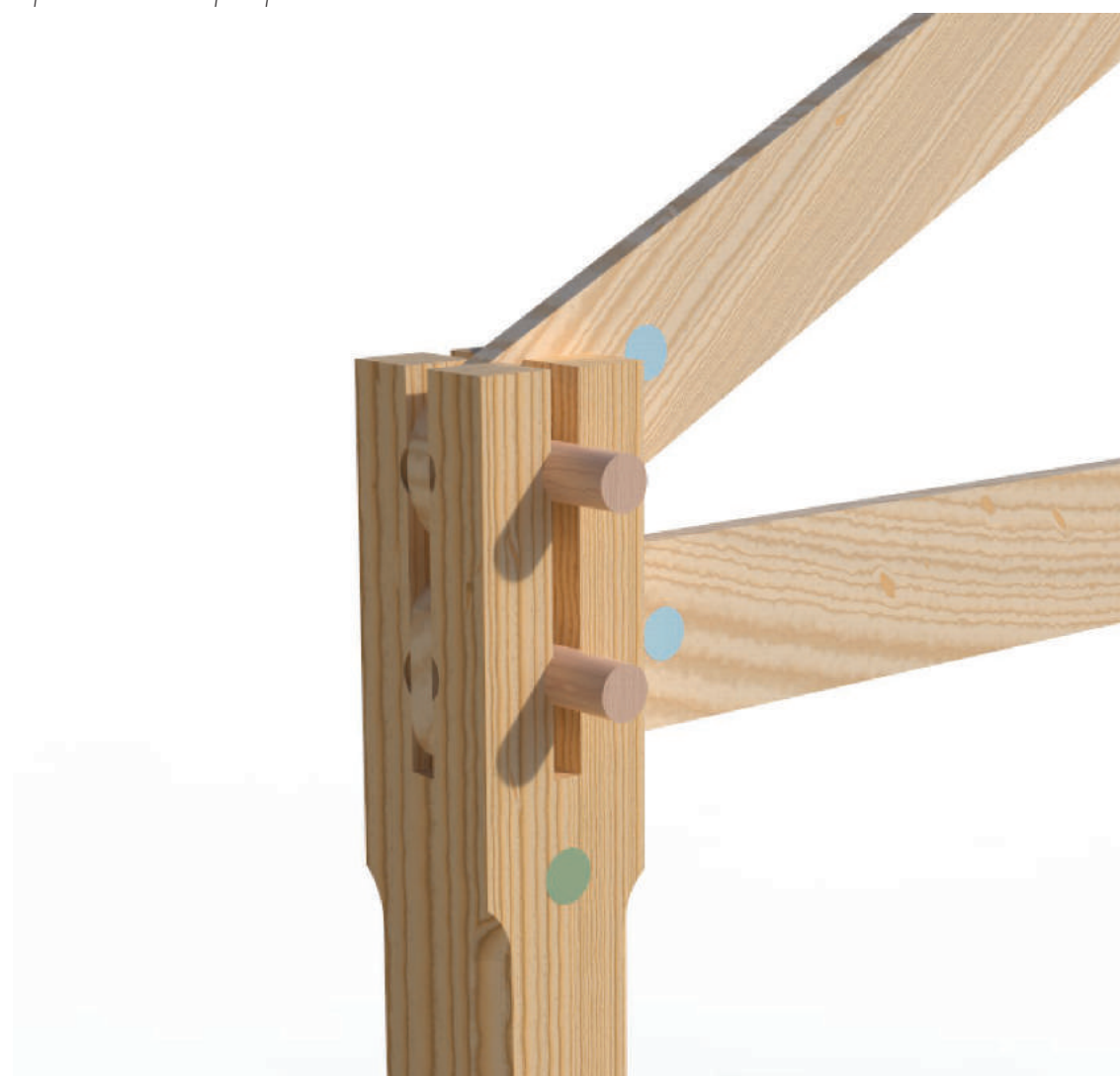
3. Le poteau 1 est fabriqué en épicéa, l'entrait et l'arbalétrier sont fabriqués en sapin et les clés sont fabriqués en hêtre.
