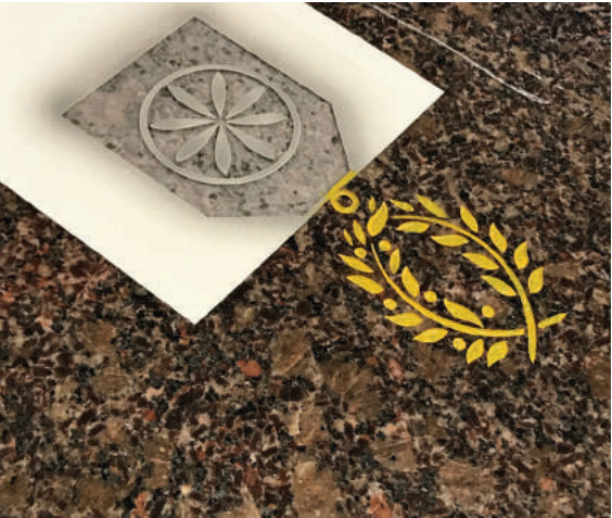
Photo 1 : Sablage avec pochoir sur granit. Photo 2 : Sablage avec finition peinture résine blanche.
