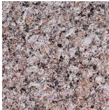
Granit « rouge corail » Granit à grain moyen d'aspect homogène et de texture régulière, de coloration rouge à rouge foncé ponctuée de petites taches de feldspaths rose et rouge brun.
