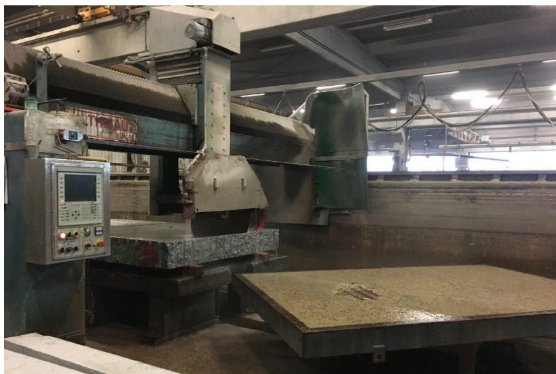
3. Mise en place des tranches brutes sur les machines. 4. Découpe des tranches de granit à l'aide de machines à commande numérique.
