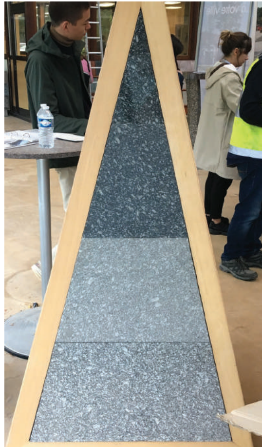
Les différents types de finitions de haut en bas : polie, adoucie, grenillée, flammée
