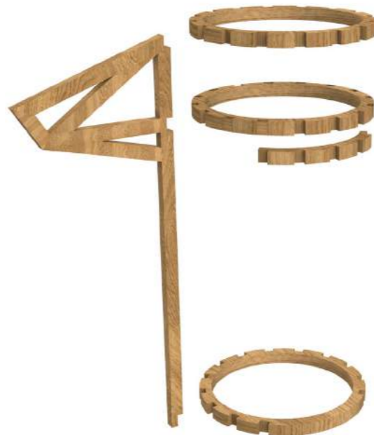
Éclaté d'un morceau de la charpente
