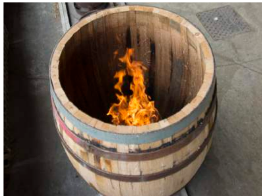
Tonneau sur chauffette
