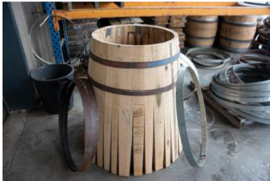
Tonneau en cours d'assemblage
