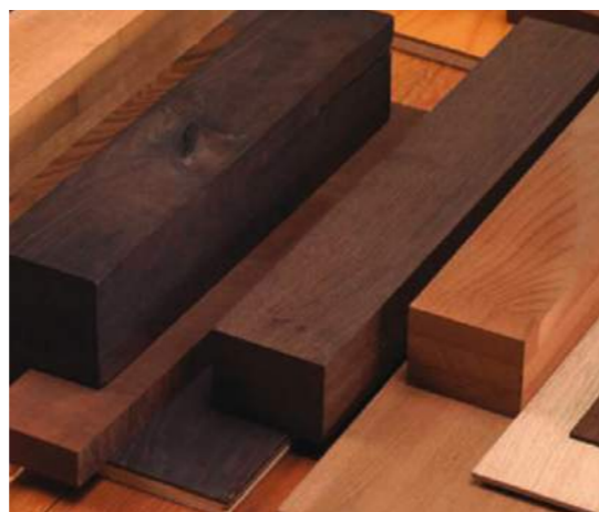
Bois thermo traité à différents niveaux de chauffage ©DursefSA
