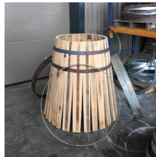
4. Montage de mise en robe.
