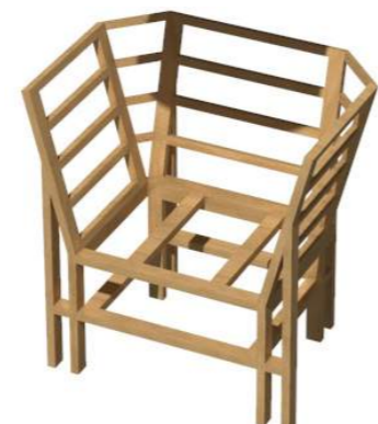
Cette image montre les trois différentes parties du fauteuil : les tuiles du dossier, et l'assise sont enveloppées par la structure charpentée.
