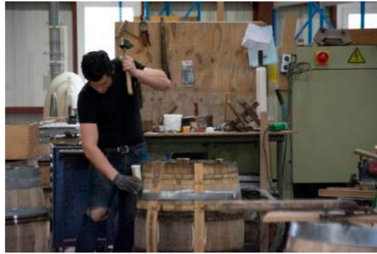
Tonnellier de la Tonnellerie de Champagne mettant en place le cerclage métallique.
