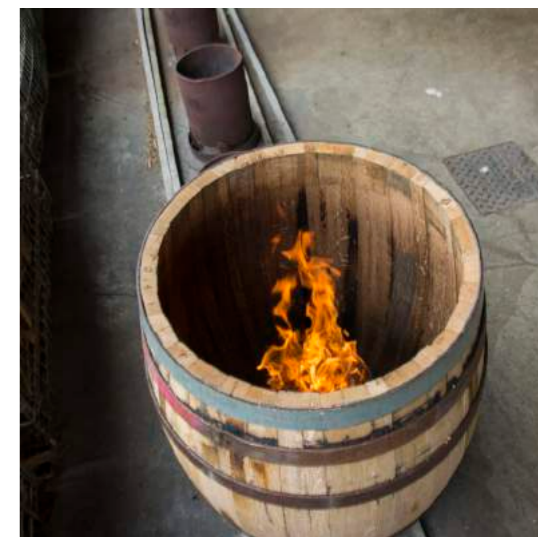
5 Tonneau sur chaufferette.
