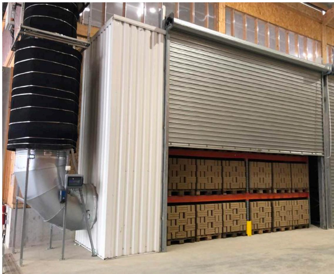
Tunnel de séchage des BTC
