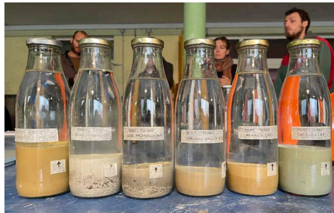
Test de la bouteille réalisé sur différentes terres. Résultat après 24h de décantation
