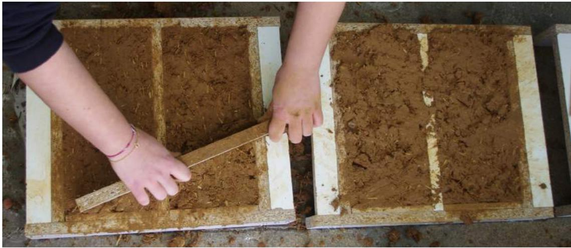
Passage d'une règle sur le moule afin d'obtenir une finition homogène et un niveau similaire, avant de retirer le moule.
