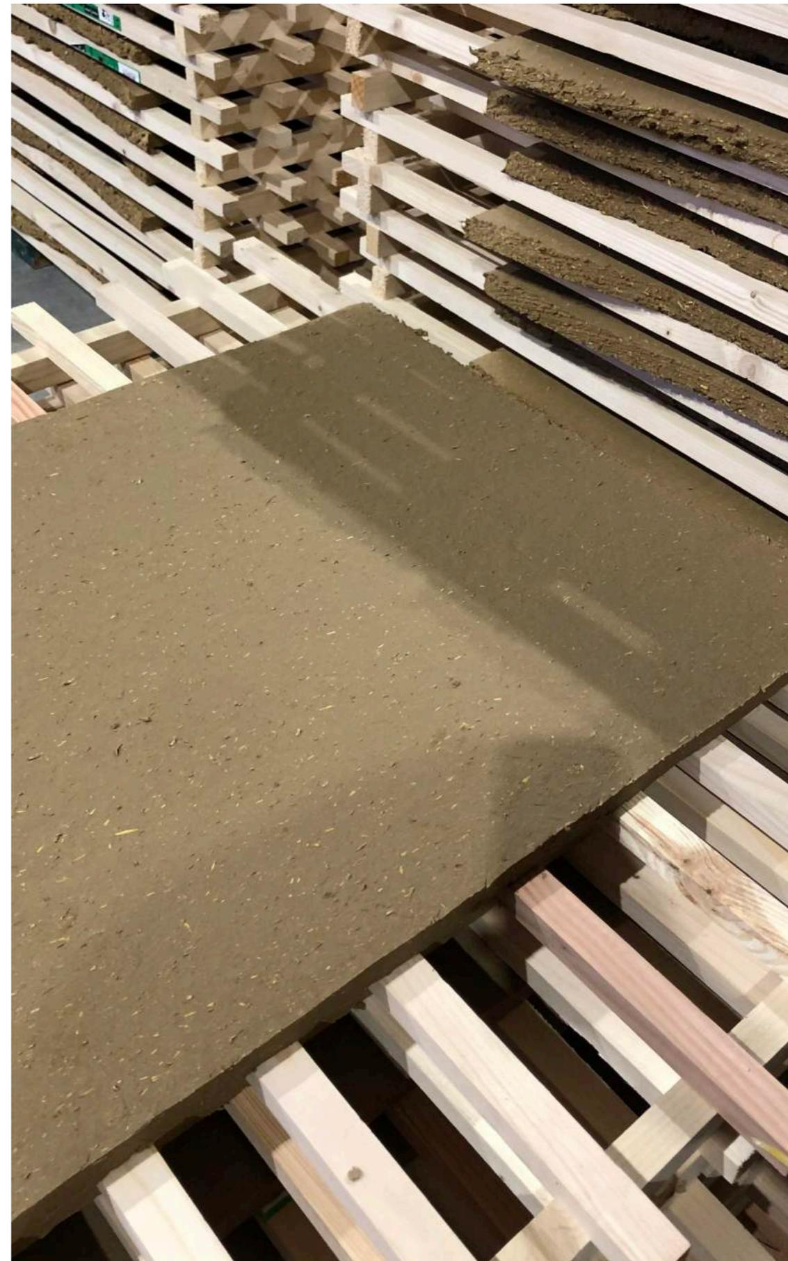
Panneau de terre crue (PTC) réalisé par Cycle Terre
