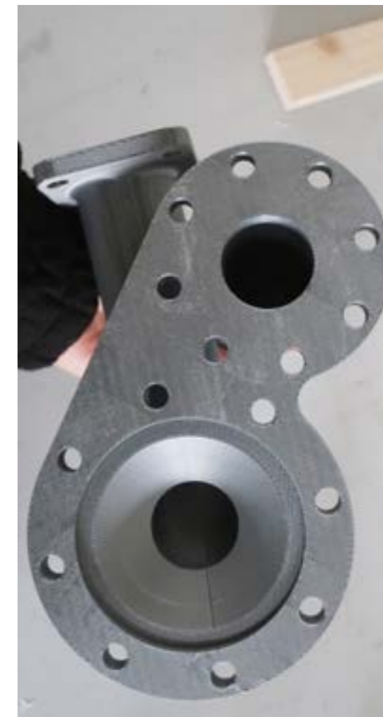
Impression 3D en PLA réalisée à l'atelier
