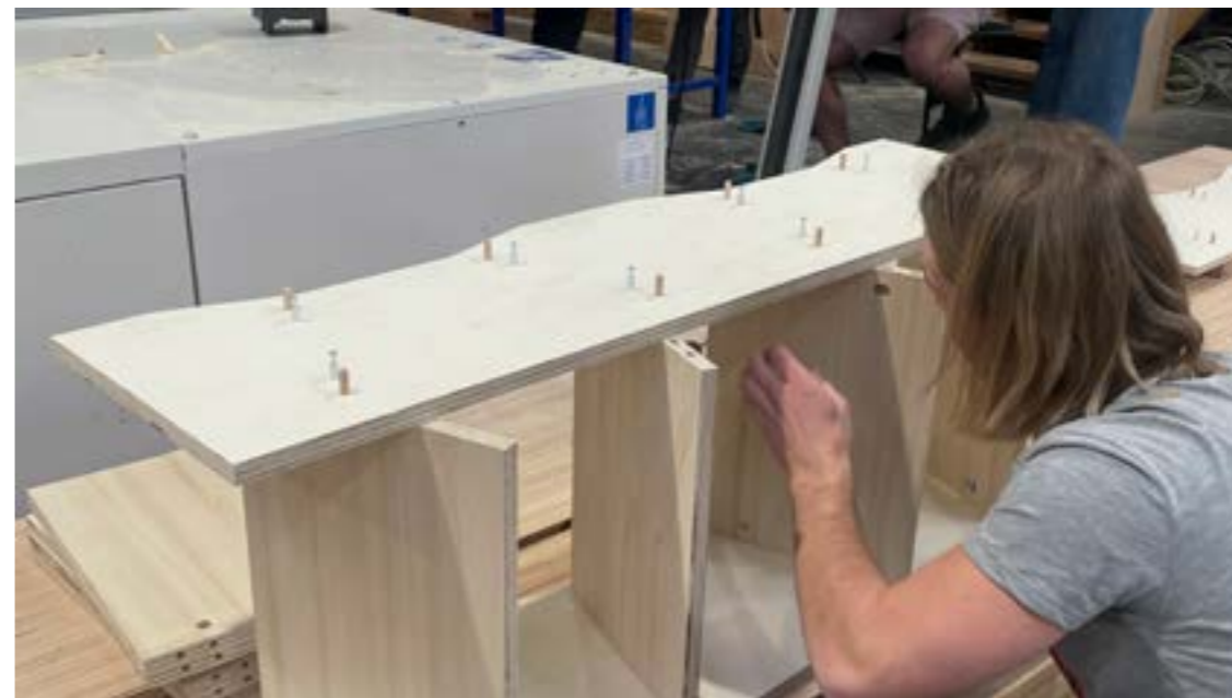
Étape 3 Assemblage des différentes parties usinées comprenant une phase de vérification, type contrôle de charge et défauts apparents, avec Arthur Richalet, étudiant de l'ENSTIB, qui a réalisé le prototype.
