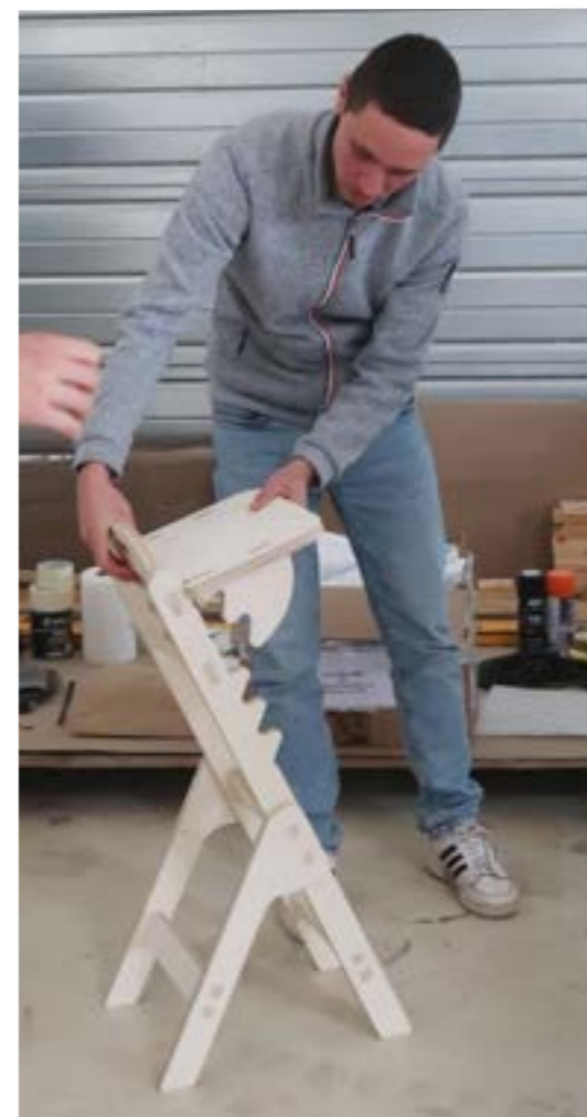
Démonstration d'un tabouret réglable conçu par usinage numérique
