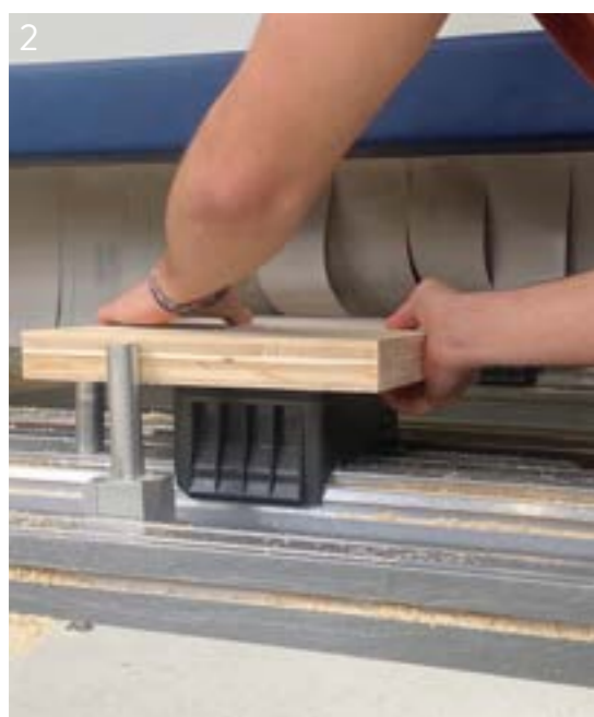
2 Mise en place du panneau trois plis sur la CNC 5 axes
