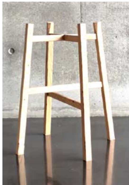
Les traverses basses sont espacées de 4 cm pour pouvoir imbriquer les deux parties du tréteau l'une dans l'autre.
