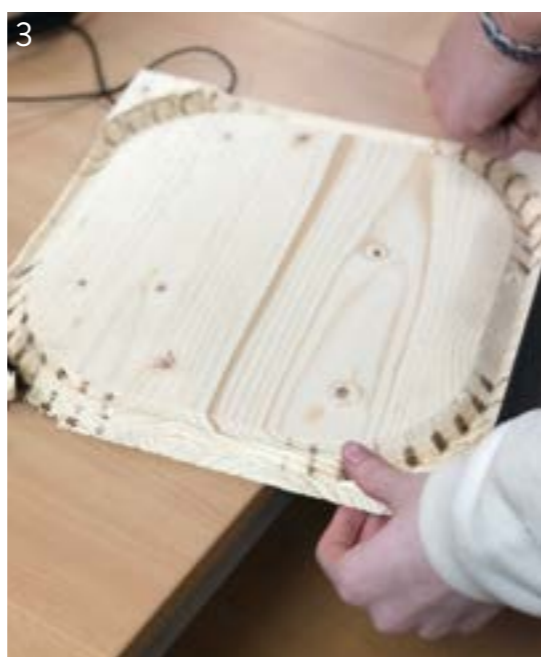
3 Premier test râté d'usinage à la CNC 5 axes
