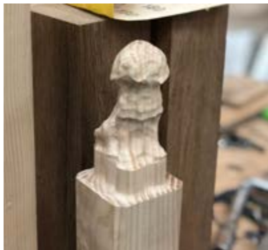
Dégrossissage d'une statuette faite par la CNC 7 axes
