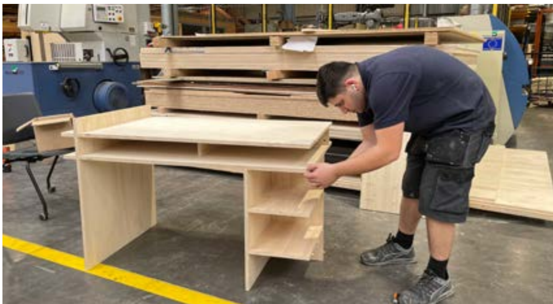
Montage, test de contreventement et ajout d'un caisson par Vardgues, étudiant en licence ameublement bois
