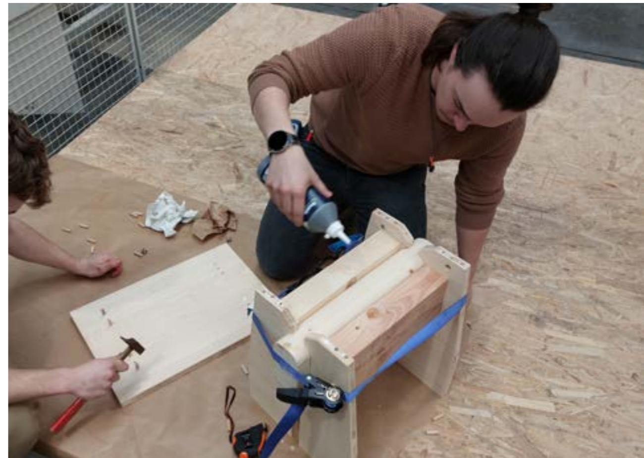
Assemblage provisoire par collage, type colle à bois
