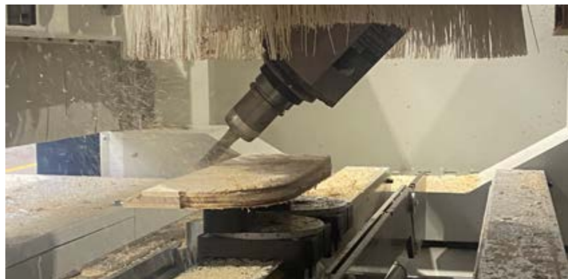
Usinage des angles à 45°
