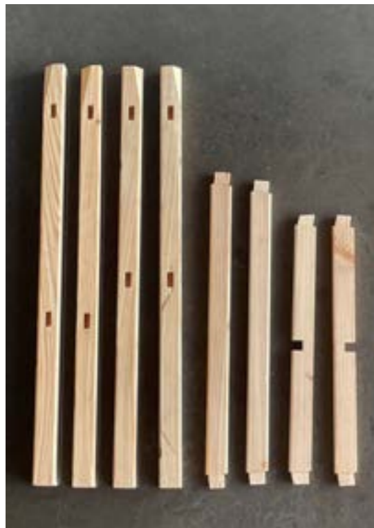
Usinage des assemblages, type tenon-mortaise
