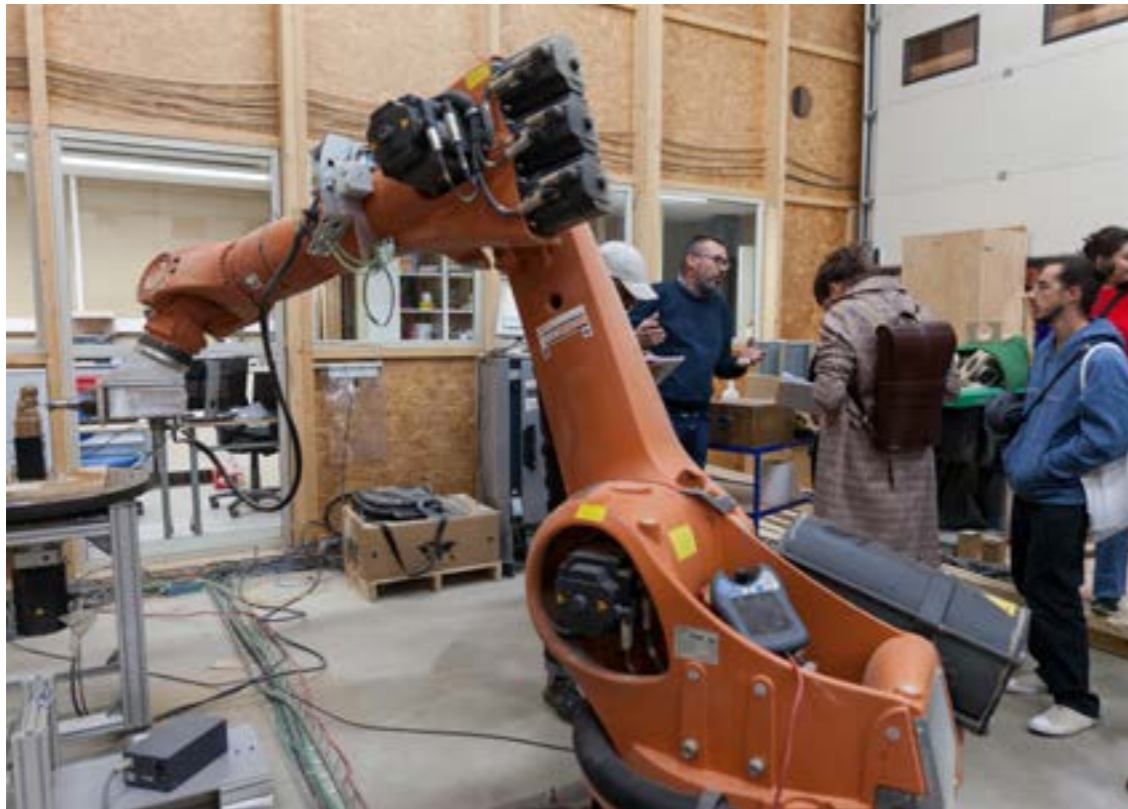
Machine automate CNC sept axes permettant de façonner jusqu'aux détails d'une statuette, © Leelou Guevel
