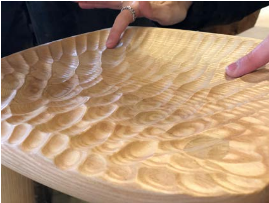
Détail de l'assise du tabouret réalisé à la fraiseuse à commande numérique (CNC)
