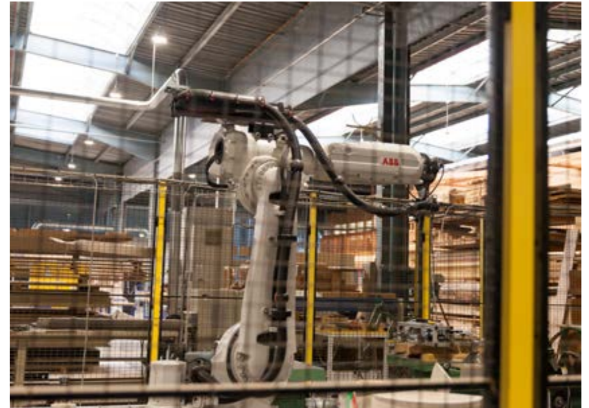
Robot automate permettant d'effectuer de manière mobile tout usinage traditionnel au sein d'une cage © Leelou Guevel
