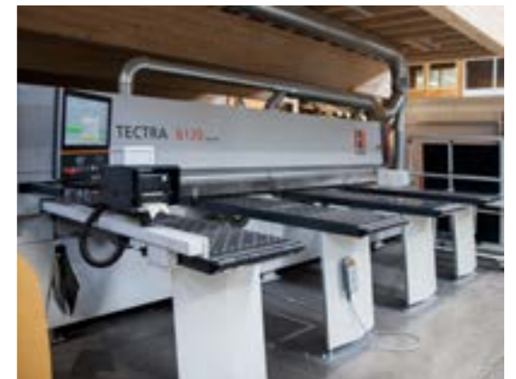
CN découpe de panneaux et son écran de commande, © Leelou Guevel
