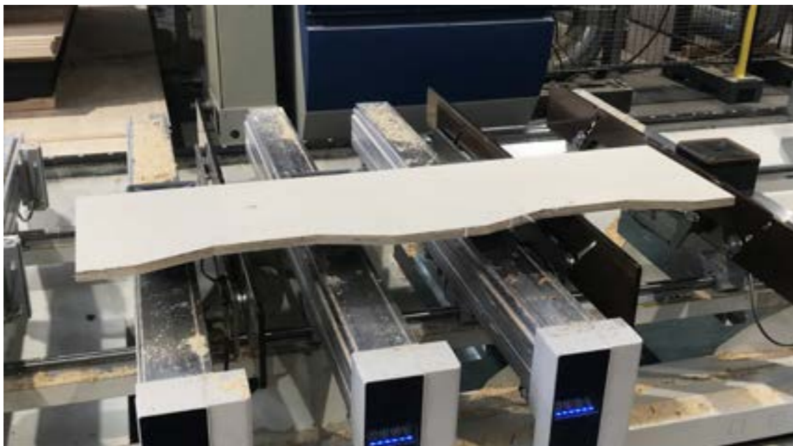
Étape 1 Usinage des panneaux à la CNC et perçage pour les chevilles et les vis excentriques.
