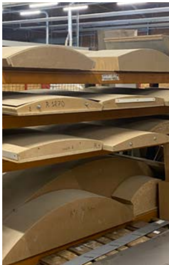
Moules pour former des plaques de résine
