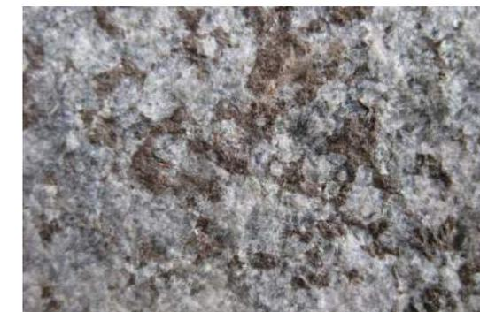
**L'oxydation** : c'est la coloration de la surface du granit due à l'altération du feldspath qui prend une couleur rouille et du désagrégement de la biotite (mica), créant une poudre fine argileuse seulement à la surface.
