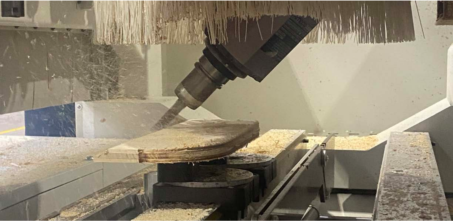
Usinage des angles à 45 degrés
