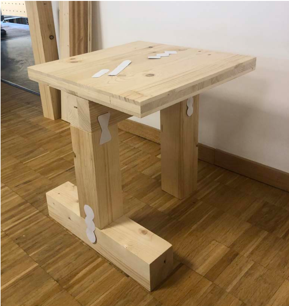
Découpe de clés et placement sur le tabouret
