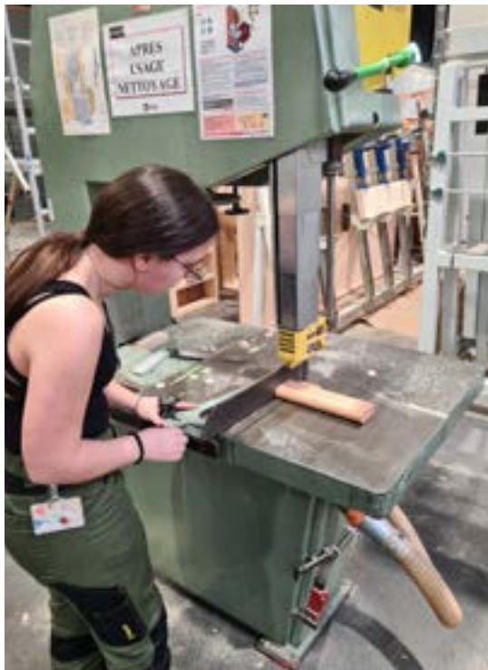
Fabrication de la traverse avec la scie à ruban
