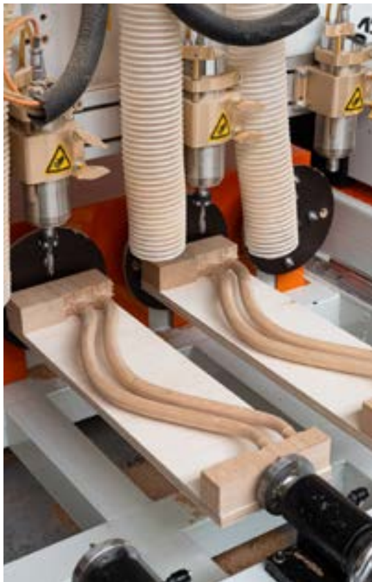
CNC 4 axes réalisant les usinages de pieds
