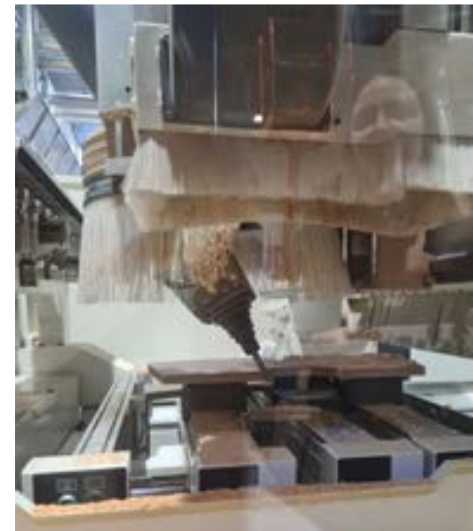
Usinage de l'ouverture à 30°
