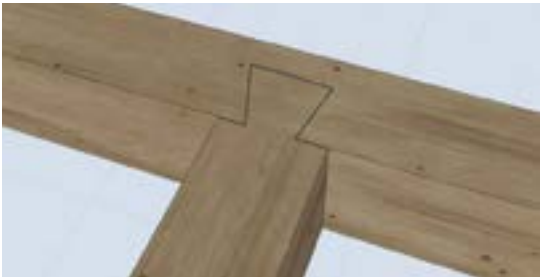
Schéma d'assemblage en queue d'aronde
