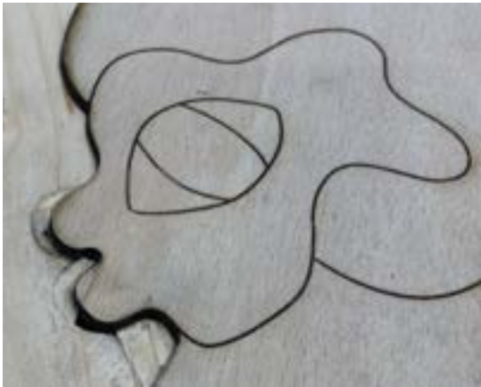
Défaut d’usinage au niveau de la bouche de la fée
