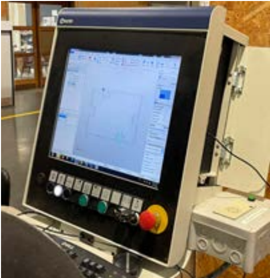
Programmation d'un plateau sur le logiciel Maestro qui est utilisé pour la CNC 5 axes
