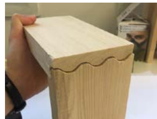
Usinage et test de l'assemblage vague à la CNC 3 axes
