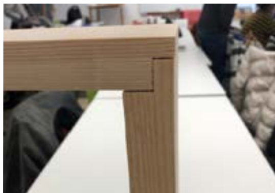
Vue de profil du premier test d'assemblage type queue d'aronde avec épaulement
