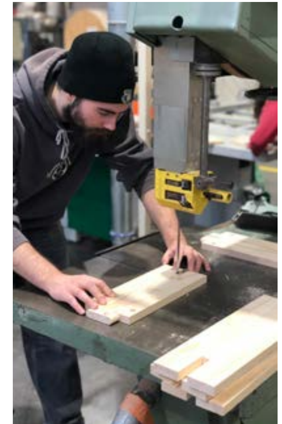
Ajustement de l'assemblage mi-bois des pieds
