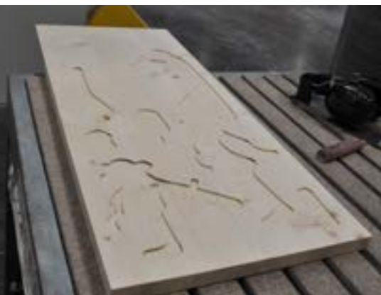
Usinage du motif sur un seul panneau
