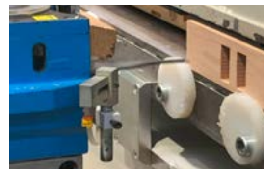
Réalisation des mortaises avec la mortaiseuse
