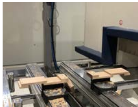
Un des usinages techniques pendant lequel chaque pièce de bois est tenue par une unique ventouse
