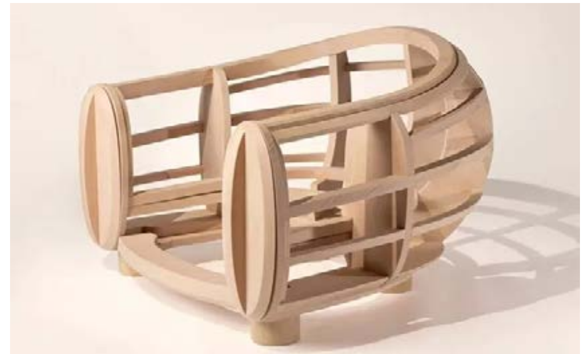
Fabrication du squelette du fauteuil « Ours polaire » de Jean Royère (1947)
