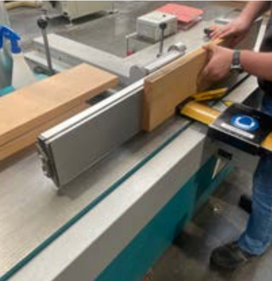
Passage des pièces en hêtre à la dégauchisseuse avant collage
