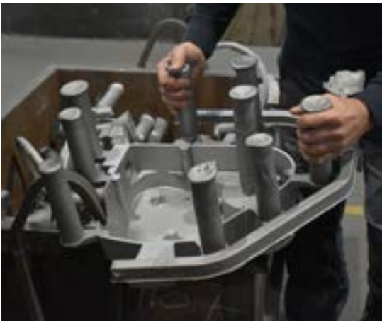
Pièce sortie du moule avec les cheminées apparentes
