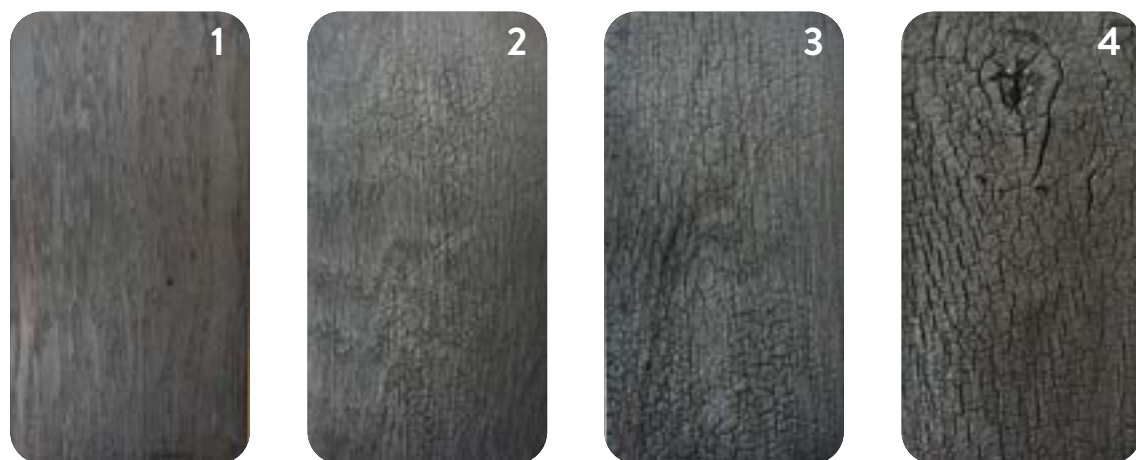
Échantillons de bois brûlé, tests de carbonisation
