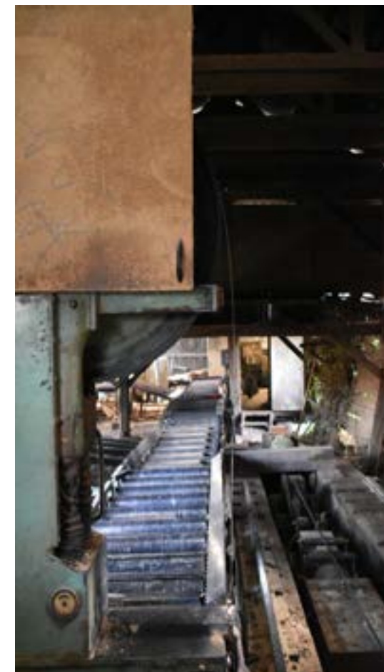
Les plus anciennes machines de la scierie en activité : scie à ruban verticale de 1970 et son charriot de 1942
