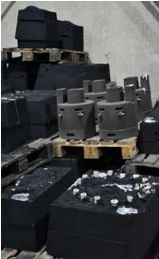
Moule en phase de refroidissement après coulée
