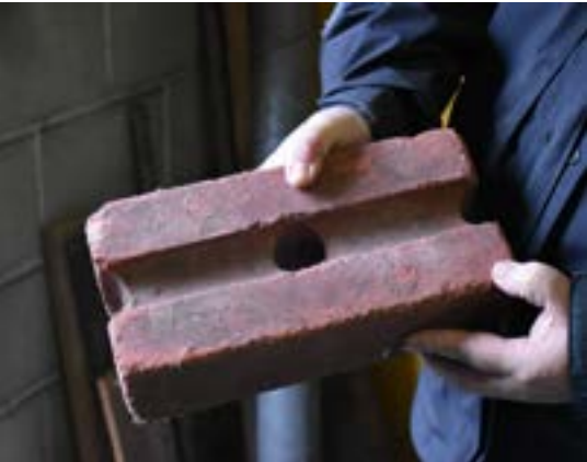
Brique pour passage des gaines électriques
