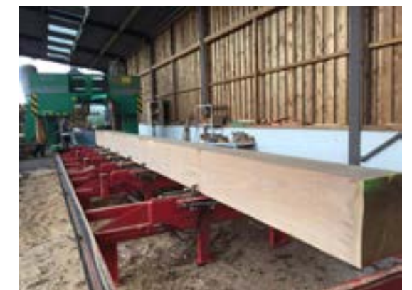
Résultat d'une découpe à la scie à grume horizontale
