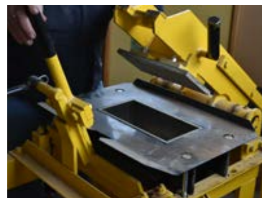
Moule dans lequel on insère le mélange de terre
