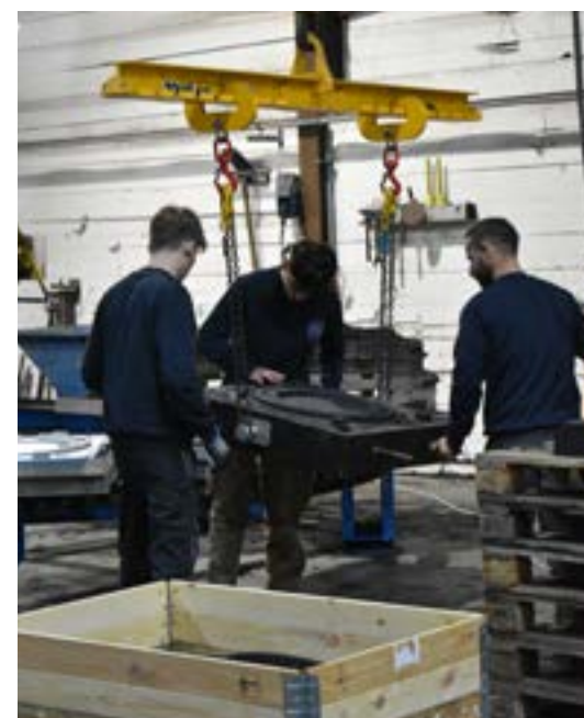
Retrait du positif dans le moule
