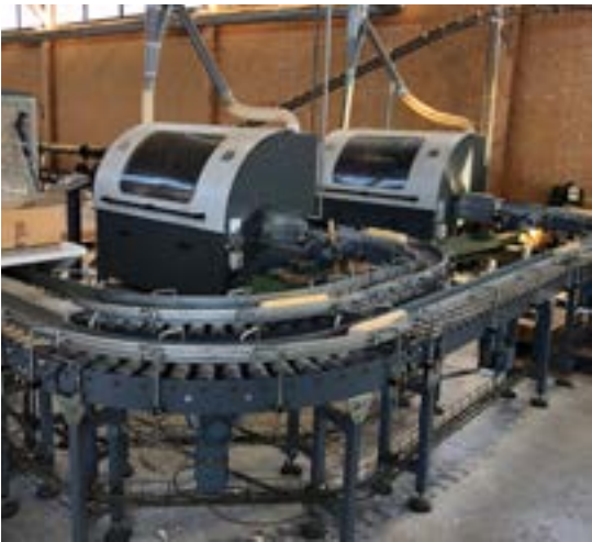
Ligne de production où la sciure de bois est compactée
