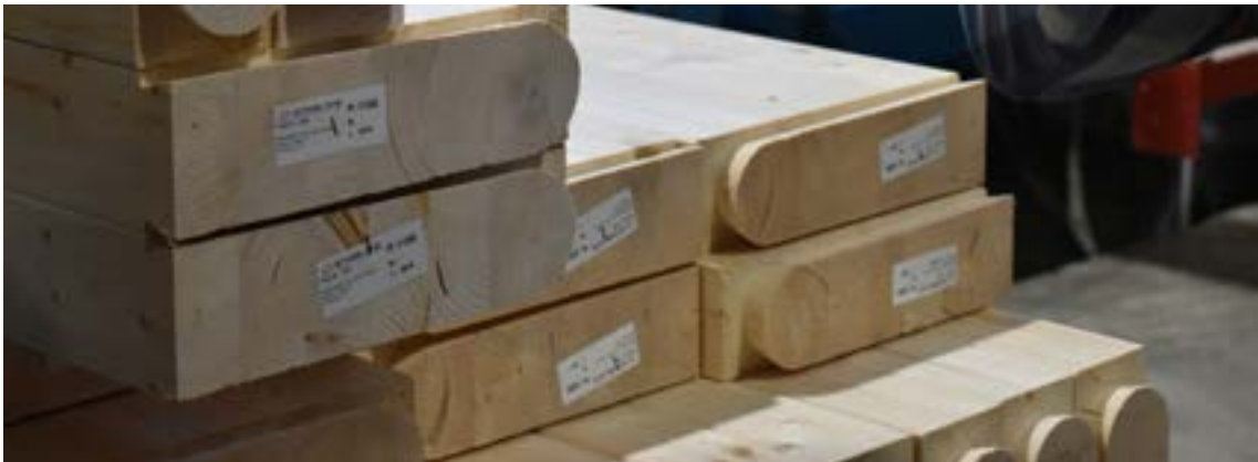
Poutres usinées par l'entreprise Stabilame
