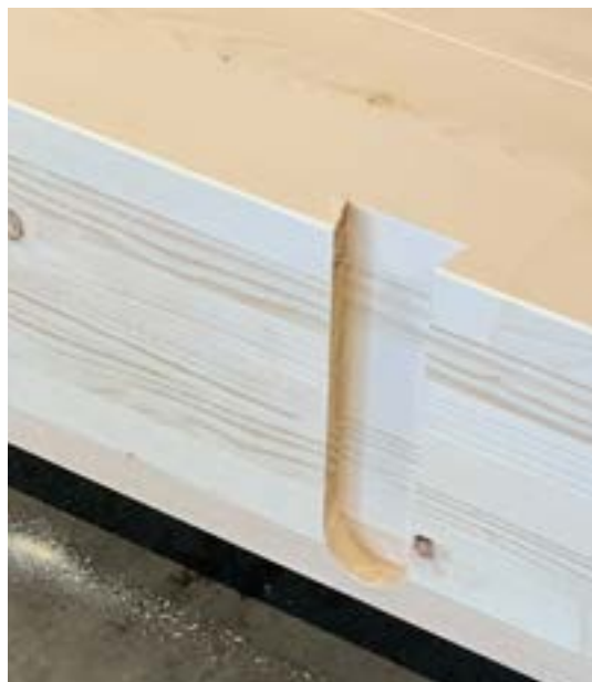
Principe d'assemblage en queue-d'aronde
