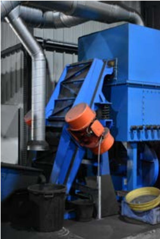
Broyeuse par vibration des moules
