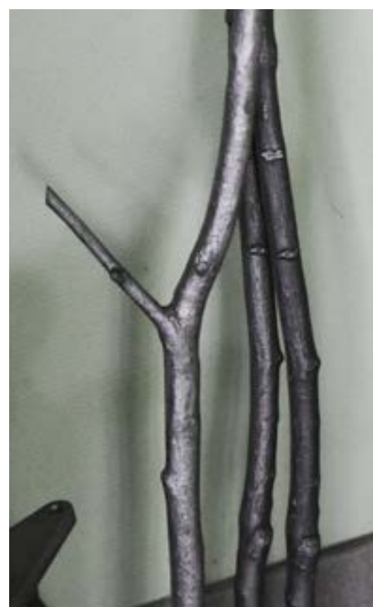
Exemple de branches en aluminium fabriquées par la fonderie FRA Design
