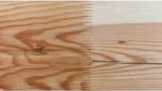
Assemblage en micro-entures réalisées à l’abouteuse
