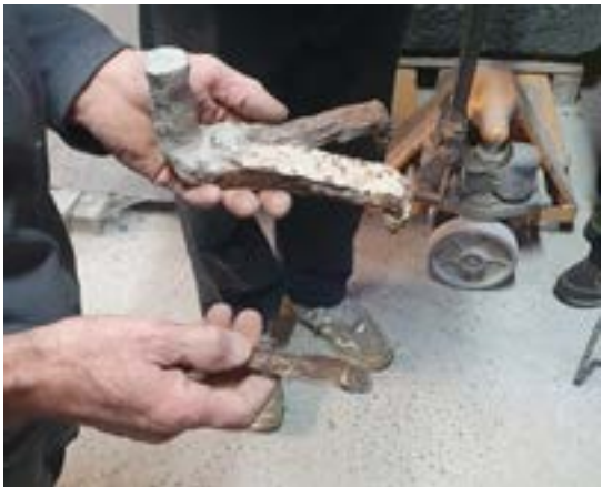
Exemple d'agrafes rouillées et remplacées
