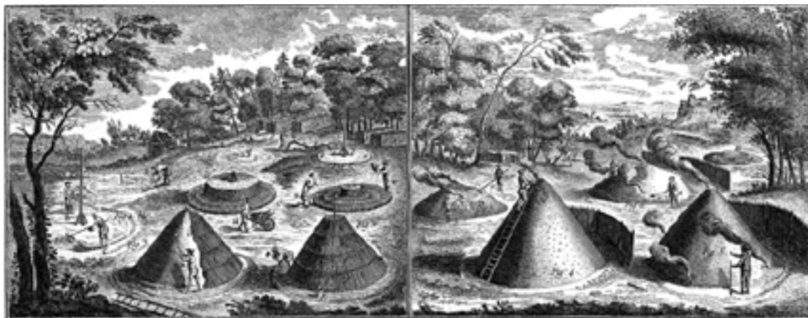
Représentation schématique de la technique de fabrication de charbon de bois en meule conique.
